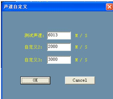
注：如果自定义声速的话，需在声速设置框内的材质下拉框选取对应的自定义声速项。
